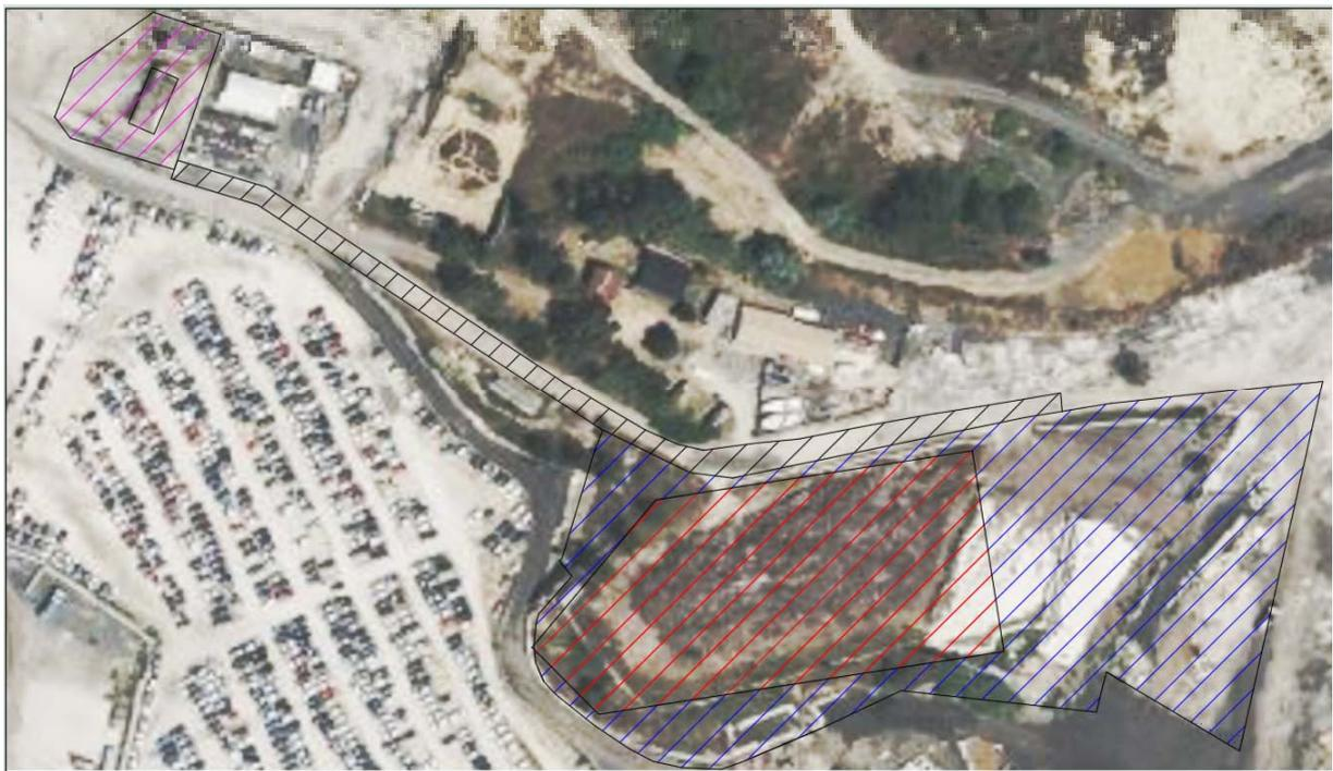
**Figura 1.28.** Planimetria di progetto- in campitura rossa sono evidenziati l'attuale area di stoccaggio e di recupero, oggetto di ampliamento, e l'area della pesa/uffici
