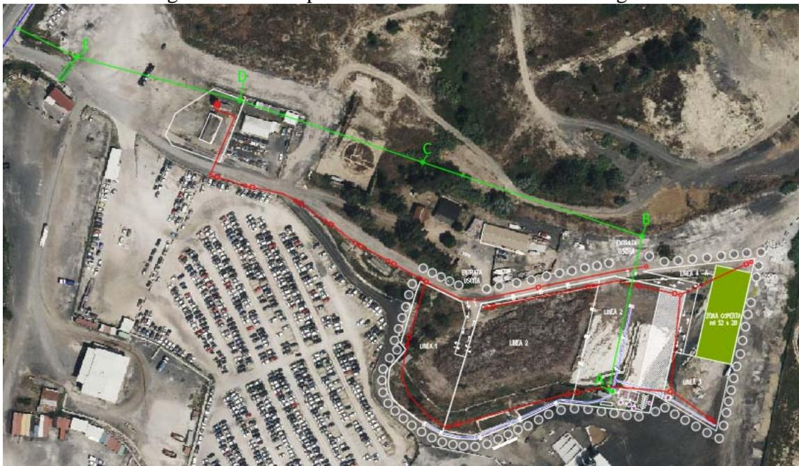
**Figura 1.33.** Linea fognaria di seconda pioggia per l'immissione nel Fosso di Fontignano e in rosso quella elettrica
